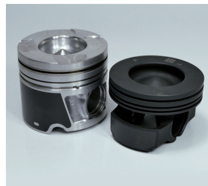
Рисунок 3: Алюминиевый и стальной поршень с графитовым покрытием юбки
